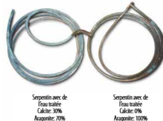
l'amélioration de l'échange thermique grâce à la réduction des dépôts de tartre permettant de réaliser d'importantes économies d'énergie. L'aspect le plus significatif par rapport à la consommation humaine de l'eau ainsi traitée est cependant liée à la richesse des minéraux et à leur micro-cristallisation :
