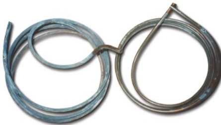
Змеевик с необработанной водой Кальцит: 30% Арагонит: 70%
